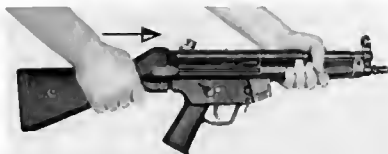
Bild 35 Zusammenetzen der Waffe
